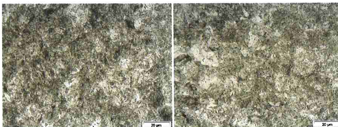
Figura 20 - Metalografia da condição inicial do disco, nas seções transversal (esquerda) e paralela (direita) com aproximação de 500 vezes e atacado com Nital.
