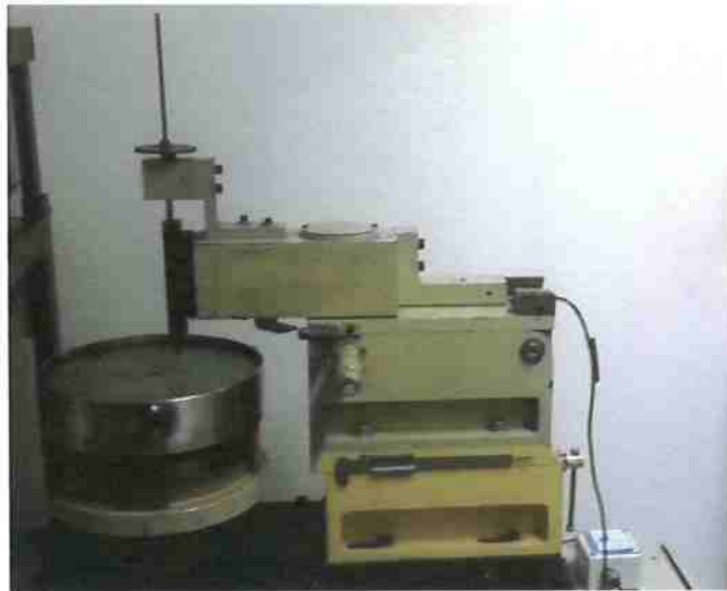
Figura 21 - Tribômetro utilizado nos ensaios pino-disco.
