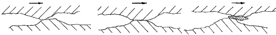
Figura 11 - Mecanismo de geração de partículas pelo desgaste por adesão (Gupta, et al., 1991).
