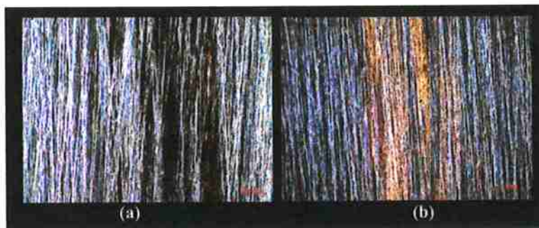
Figura 32 - Tribofilme impresso nos discos atritados com os pinos de latão 260 com diferentes cargas normais com ampliação de 12,5 vezes. As cargas normais correspondentes são: 40N (a); 50N (b).
