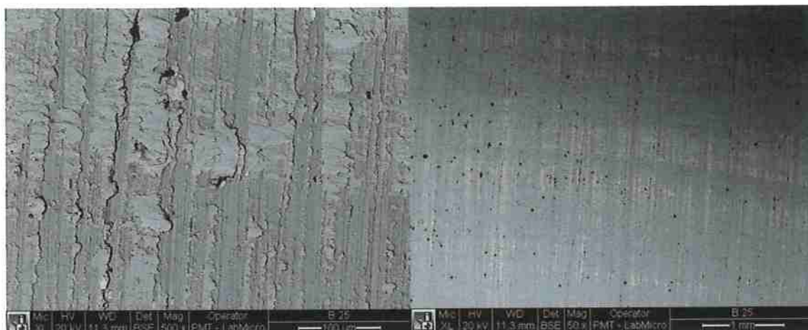
Figura 46 - Microscopia eletrônica de varredura da superfície do disco atritado pelo pino de latão 260 com carga normal de 25 Newtons.
